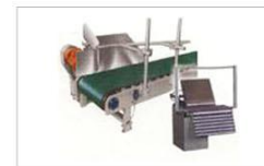
箱检剔除系统
